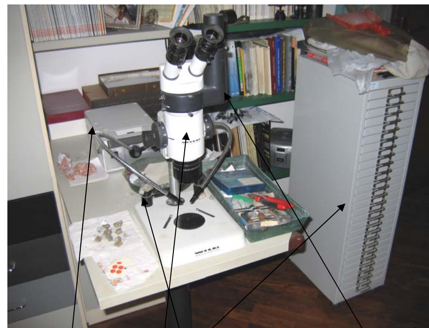
si notano A microscopio B illuminatore a fibre ottiche C cassettera D terzo oculare per fotografie attraverso il microscopio E spilli fissati su stucco
