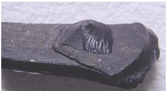
Figura 2. Aspetto di un campione di giacinto giurassico di Whitby. Dimensione 7 cm. Si noti la frattura concoide.
